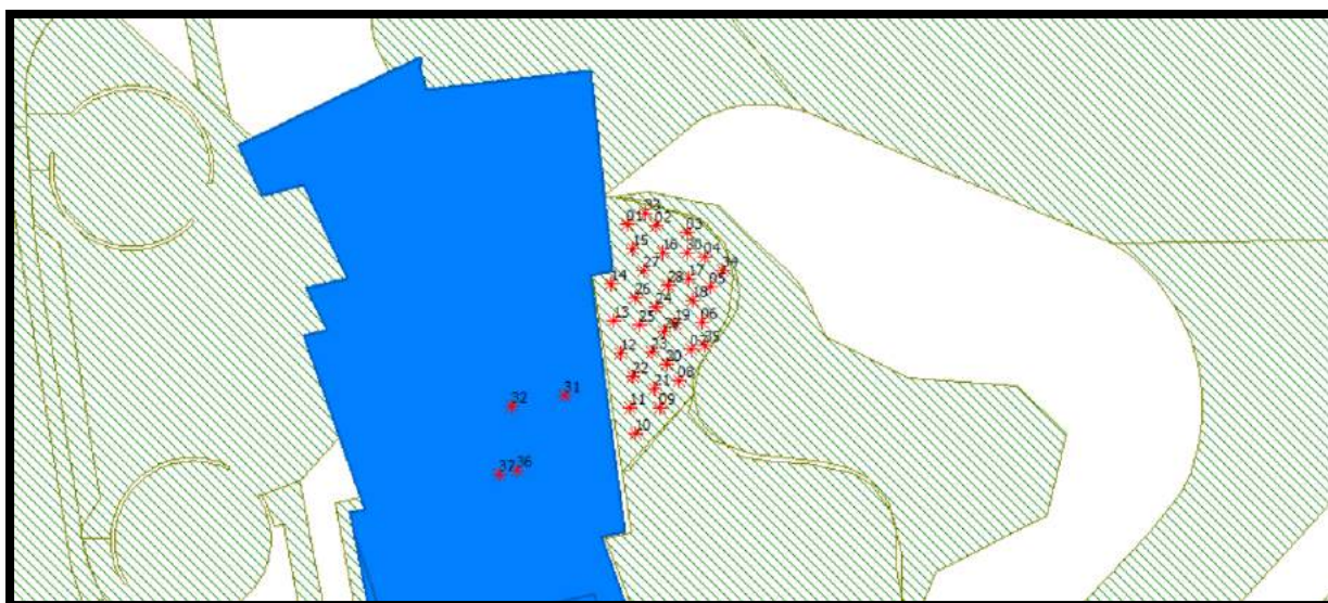
Figuur 3: Ingevoerde geluidbronnen rekenmodel (rode sterren).
